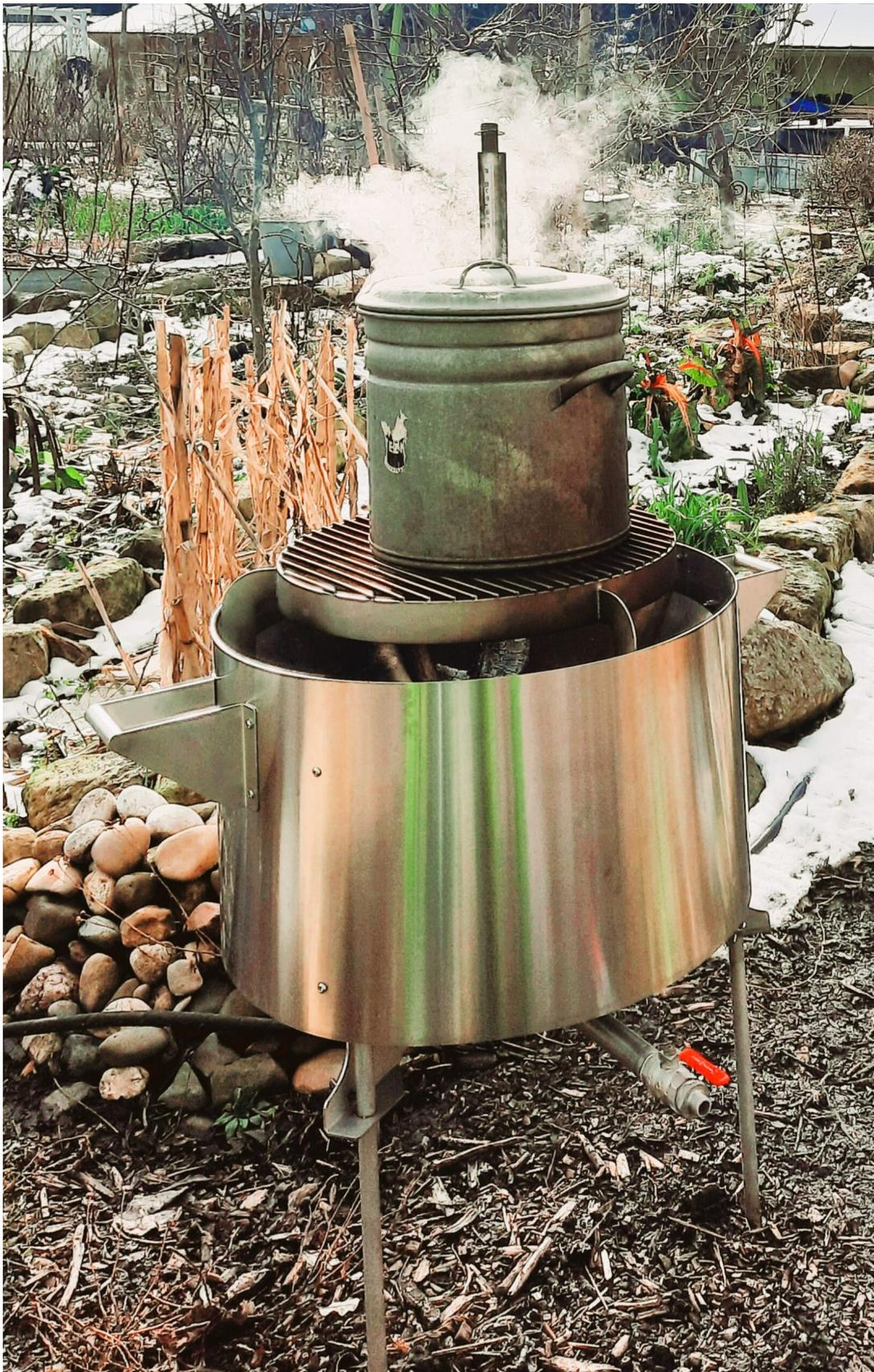
*Bei unserem Versuchsaufbau erreichten wir Temperaturen über 90 °C. Je dicker die Erdschicht ist, desto länger sollte die Dämpfdauer sein.*
